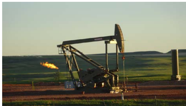
「水圧破碎を経てシェールオイルの採掘が確認できた後は、無人のポンピングユニットがひたすら原油を汲み上げます。」
